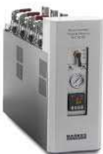
Figure 3 : Micro-chambres d'essais d'émission ( \mu CTE, MARKES)
